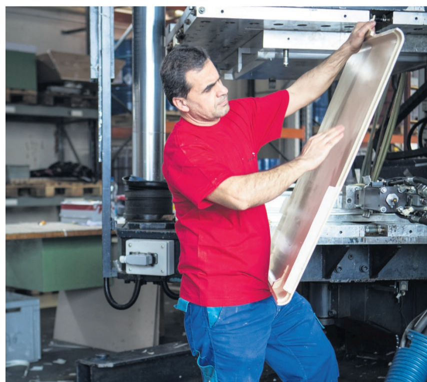
Das frisch geformte Polyurethan-Teil wird einer genauen Prüfung unterzogen. (Bild: Kanton Aargau)
