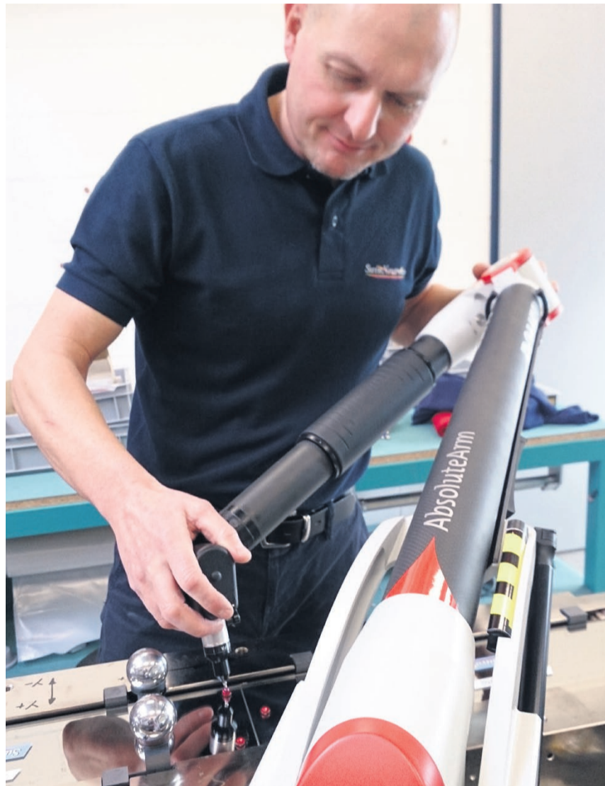
Hand in Hand mit dem Messarm: Bei der Installation von optischen Systemen zählen Genauigkeit und Erfahrung. (Bild: Heinz Haug)
